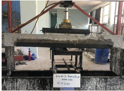
%1 hasarlı kirişin güçlendirme sonrası göçme durumu
