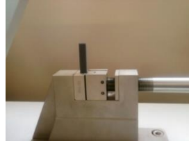
řekil 2: DeneY numunesinin çektik (izod) darbe test cihazına bağlanması
