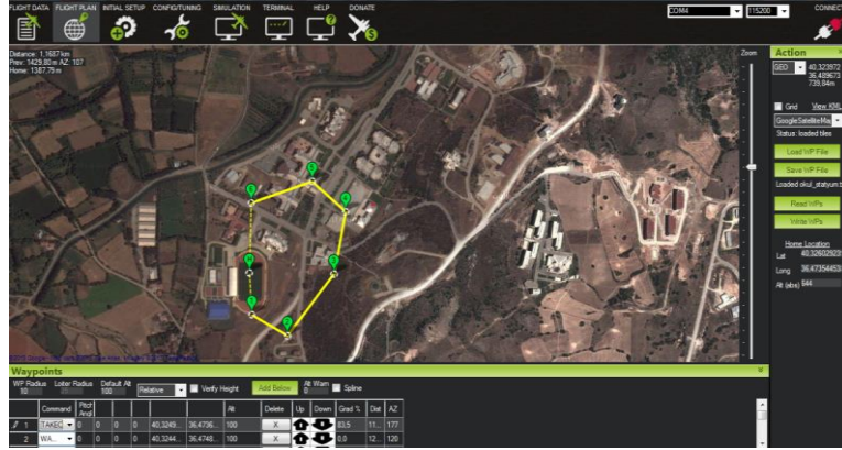
Şekil 3: Mission Planner uçuş koordinatlarının oluşturulması (APM)
