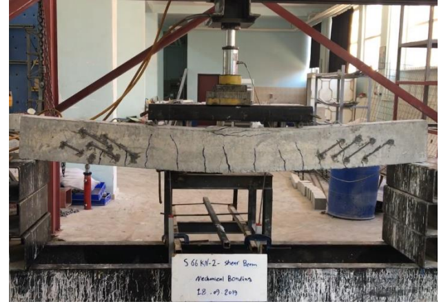
i) PDSB-%85) Nolu kirişin güçlendirme sonrası göçme durumu
