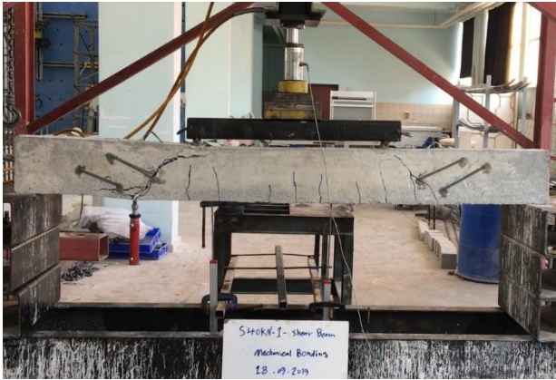
c)(PDSB-%50) Nolu kirişin güçlendirme sonrası göçme durumu f)(PDSB-%65) Nolu kirişin güçlendirme sonrası göçme durumu
