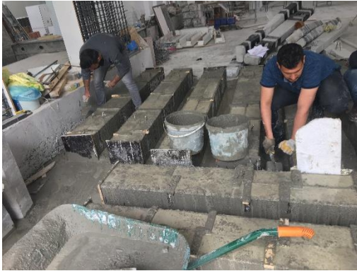
c) Numunelere beton döküm aşaması
