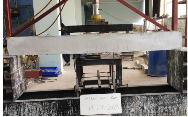
h) %85 Hasarlı kiriş (PDB-%85)
