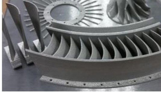
Şekil 2: Katmanlı imalat ile üretilmiş Inconel718 bisk [12]
