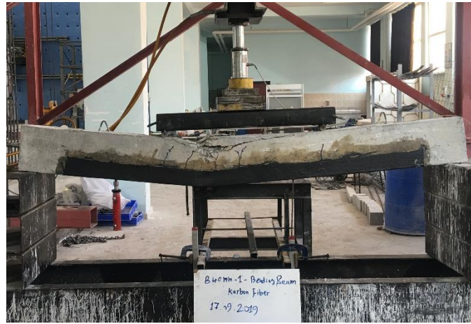
%3 Hasarlı kirişin güçlendirme sonrası göçme durumu
