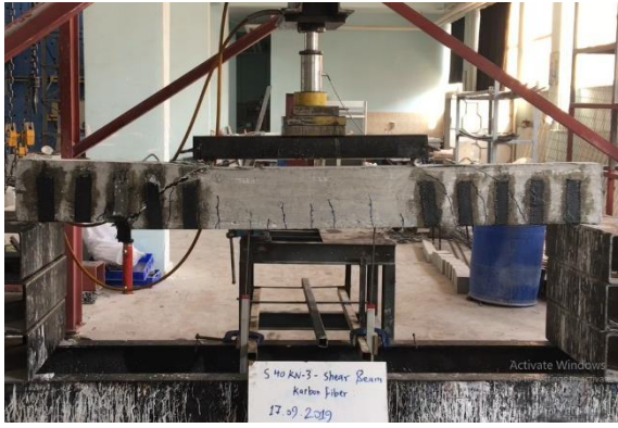
c) (PDSB-%50) Nolu kirişin güçlendirme sonrası göçme durumu
