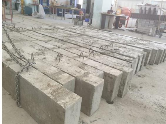
d) Üretilen betonarme kesme kirişler
