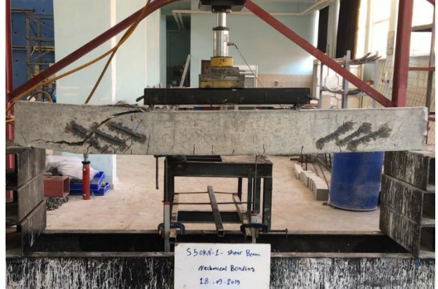
c)(PDSB-%50) Nolu kirişin güçlendirme sonrası göçme durumu f)(PDSB-%65) Nolu kirişin güçlendirme sonrası göçme durumu
