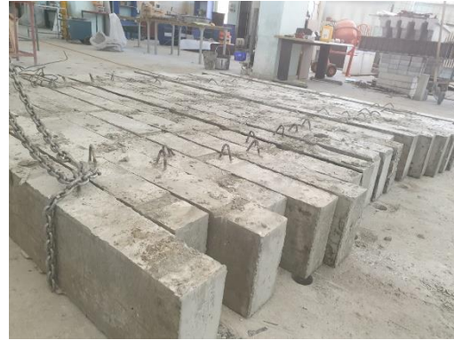
d) Üretilen betonarme kesme kirişler
