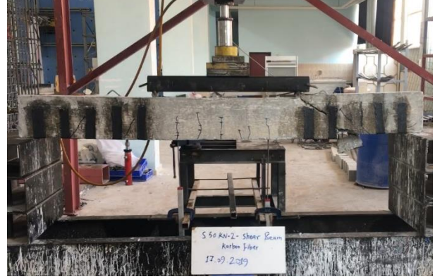
f) (PDSB-%65) Nolu kirişin güçlendirme sonrası göçme durumu
