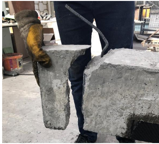
%2 Hasarlı kirişin güçlendirme sonrası göçme durumu
