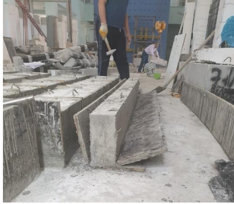
Üretilen betonarme eğilme kirişler
