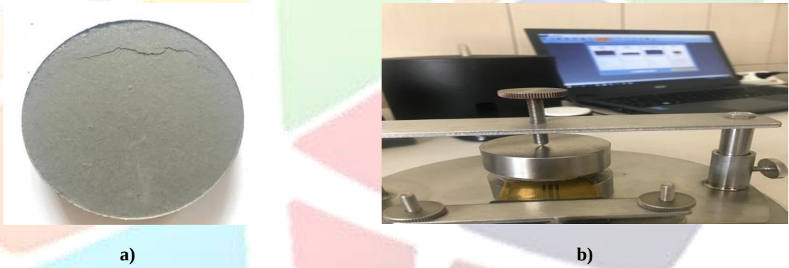
Şekil 3: a) %20 ENG kalkılı pellet, b) ENG katkı depolama malzemelerinin termal iletkenliklerinin ölçülmesi
