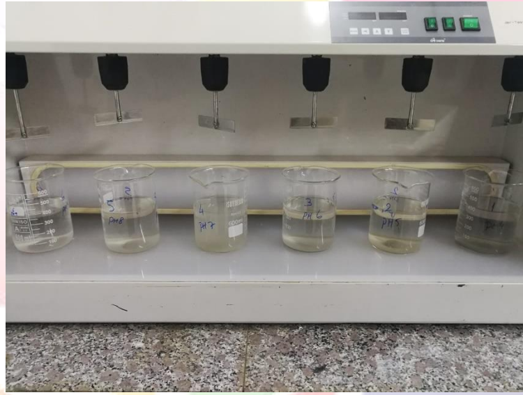
Şekil 3.6. Jar testi düzeneği arıtım çalışmaları örnekler
