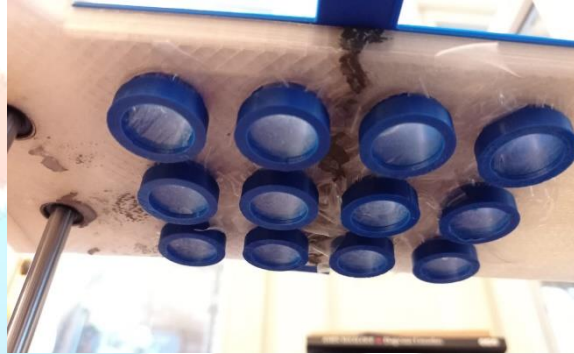
Şekil 6: Montaj tamamlandıktan sonra Well plate yapısının tabanı
