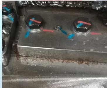
Şekil 2.7: Başarısız yüzey vernik uygulaması ve paslanma başlangıcı
