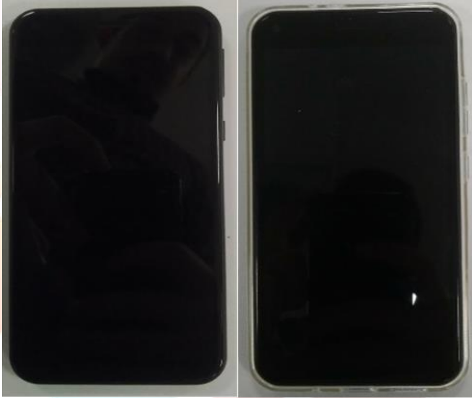
Şekil 6. Köşe atışı düşme testi için kullanılan kılıflı ve kılıfsız cep telefonları
