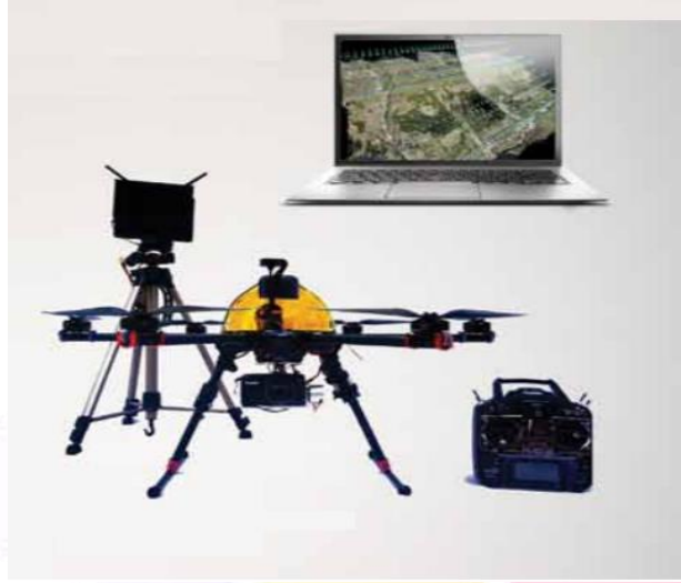
Şekil 1.1. Projede Kullanılan Multicopter, Taşıyıcı platform, Kontrol birimi ve Kamera sistemi örneği
