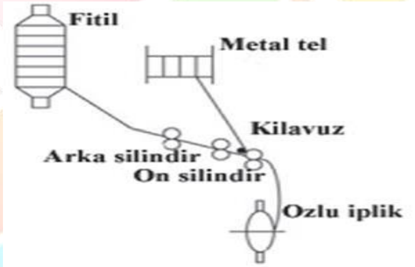
Şekil 4.1 Modifiye edilmiş ring iplik makinasında, fitil ve metal telin özlü iplik eğirme sistemi mekanizmasındaki işlevini gösteren diyagram
