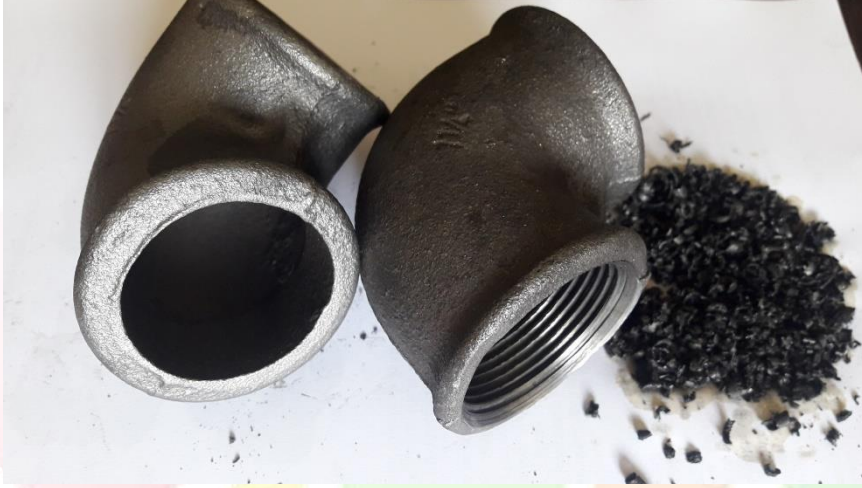
Şekil 3: Talaslı imalat öncesi ve sonrası dirsek ile talas resmi
