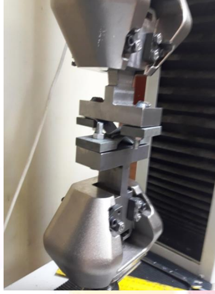
Şekil 6. Çapraz çekme tesitinde deney numunesi ve cihaz çenelerinin konumu
