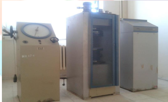
Şekil 3. ELE marka 300 ton kapasiteli pres
