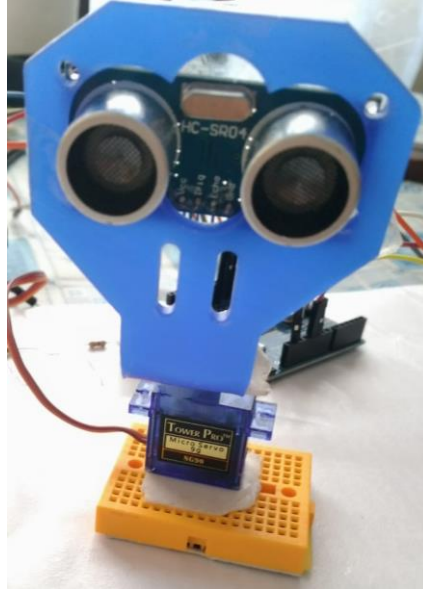
Şekil 5: Hc-sr04 sensör ve servo motorun birleştirilmiş görüntüsü.
