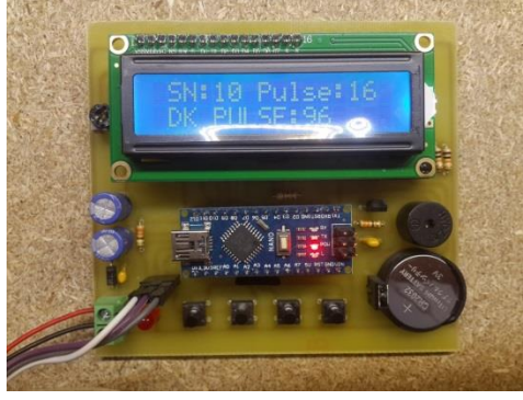
Şekil 8: Tasarlanan devrenin çalışması.
